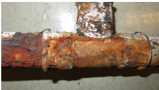
Figur 30 (Bilde: Norconsult) Elforsinkede pressfittingsrør brukt på isvannsanlegg med risiko for utvendig kondens. Det oppsto lekkasjer etter få år. Rørene ble brukt på alt av 54 mm og mindre til ventilasjonsaggregater, fancoils og kjøletak.
