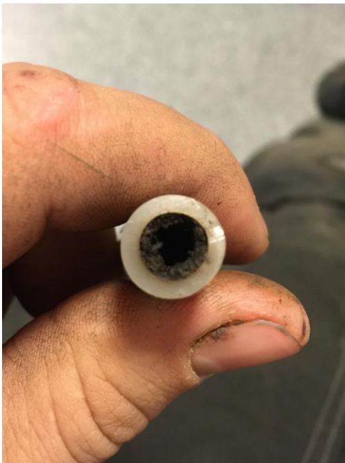
Figur 26 (Bilde: ukjent) Eksempel på avleiringer i gulvvarmerør.
